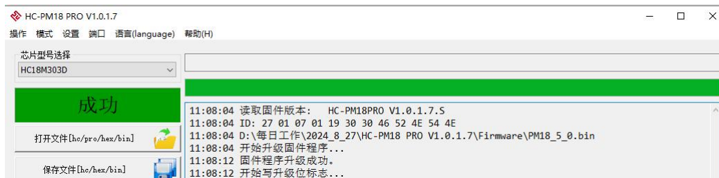
图 6-3 固件更新成功，请耐心等待 HC-PM18 PRO-V5 硬件复位，蜂鸣器“滴”一声后烧录器固件更新成功
